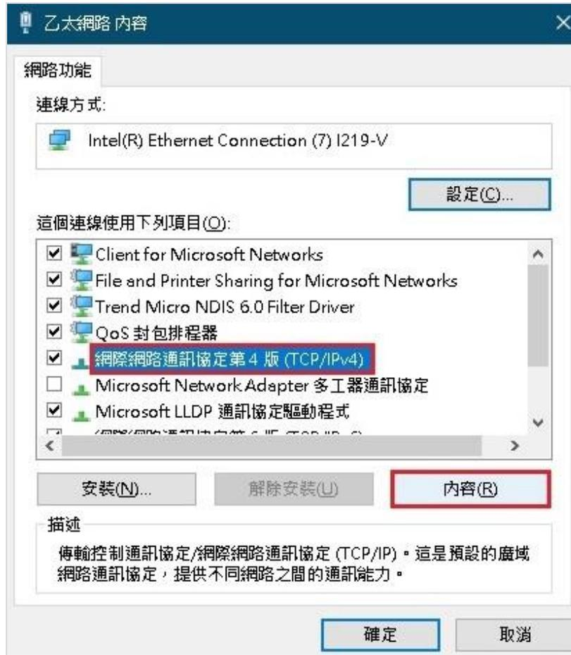
步驟七、點選  使用下列的 IP 位址及  使用下列的 DNS 位址，並輸入 IP 位址、子網路遮罩、預設閘道、慣用 DNS 伺服器及其他 DNS 伺服器 →【確定】，如下：
